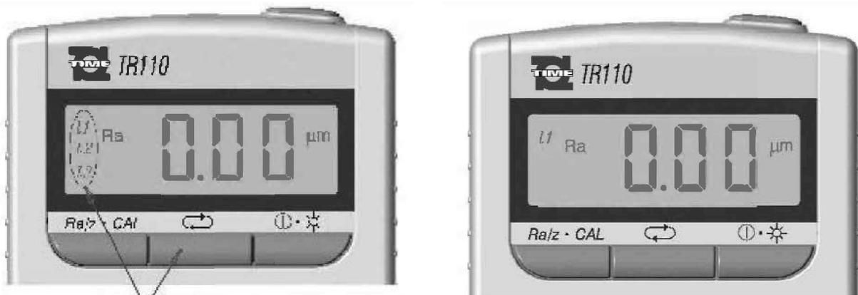
Bild 6: Einstellung der Grenzwellenlänge (rechts auf  $L1 = 0,25 \text{ mm}$ )
