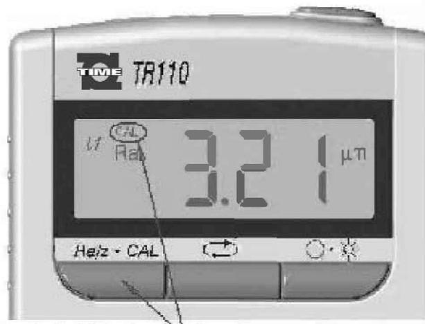
Drücken Sie anschließend die linke oder mittlere Taste um den Messwert so zu verändern, dass er mit dem Wert des Rauheitsnormales übereinstimmt. (z.B. 3.27 wie in Bild 10 dargestellt).
