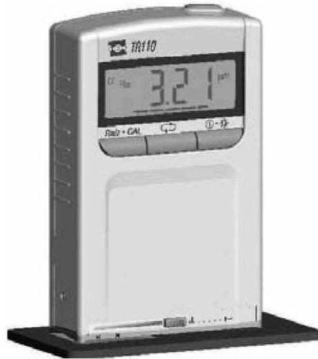
Drücken Sie anschließend die Start-Taste und führen Sie eine Messung durch. Der Messwert wird auf dem Display angezeigt. Der Messwert ist hier 3.21. Wenn der Messwert außerhalb des Toleranzbereiches liegt, der auf dem Rauheitsnormal angegeben ist gehen Sie wie folgt vor.
